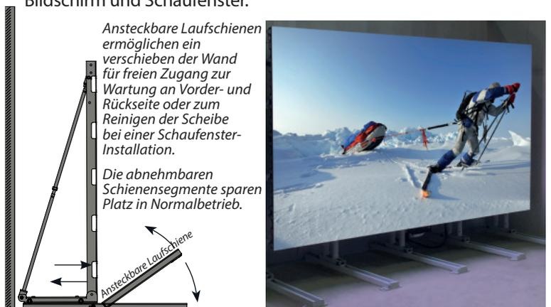
Ansteckbare Laufschienen ermöglichen ein verschieben der Wand für freien Zugang zur Wartung an Vorder- und Rückseite oder zum Reinigen der Scheibe bei einer Schaufenster-Installation.
